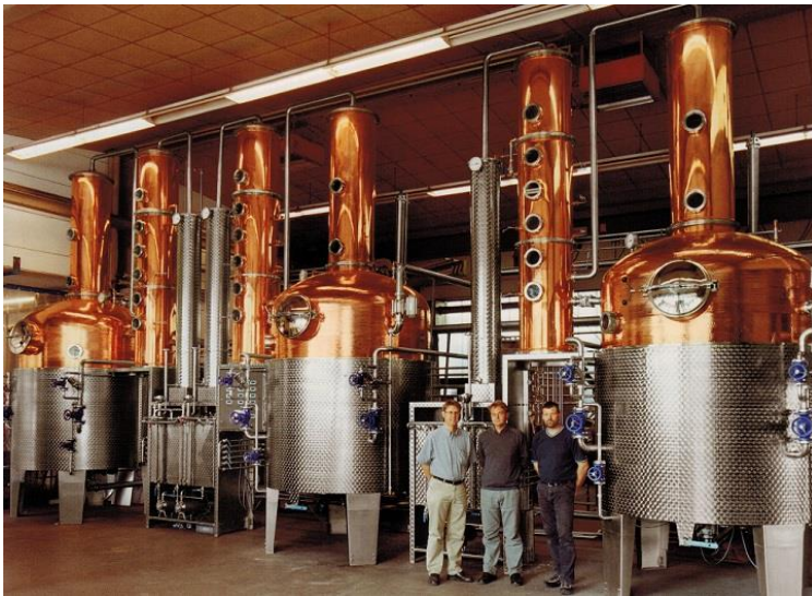
大型ウイスキー蒸留機 (5000L×3 式)
